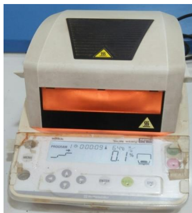
Fig. 5.2.7(a) Moisture meter
